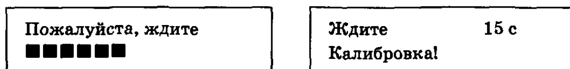
Рис. 3.21. Вид экрана во время нагрева и автоматической калибровки измерительной камеры
