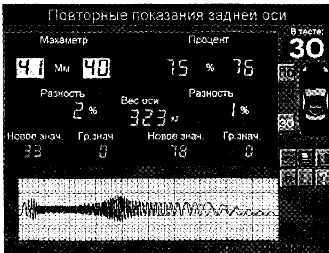
Рис. 6.5. Вид экрана в режиме проверки: а — передней оси, б — задней оси
