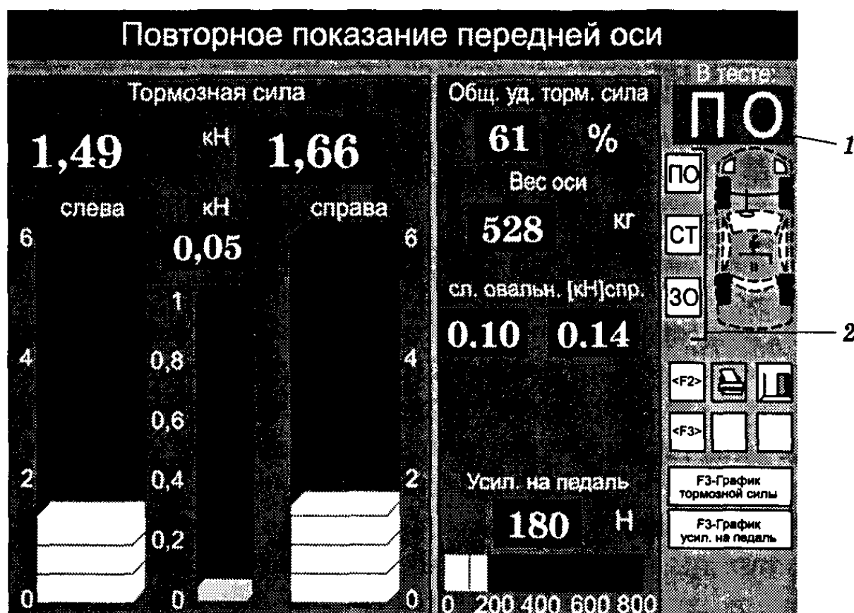
Рис. 4.4. Данные контроля тормозной системы автомобиля: 1 — проверяемая ось; 2 — кнопки переключения между осями транспортного средства; ПО — рабочий тормоз передней оси; СТ — стояночная тормозная система; ЗО — рабочий тормоз задней оси
