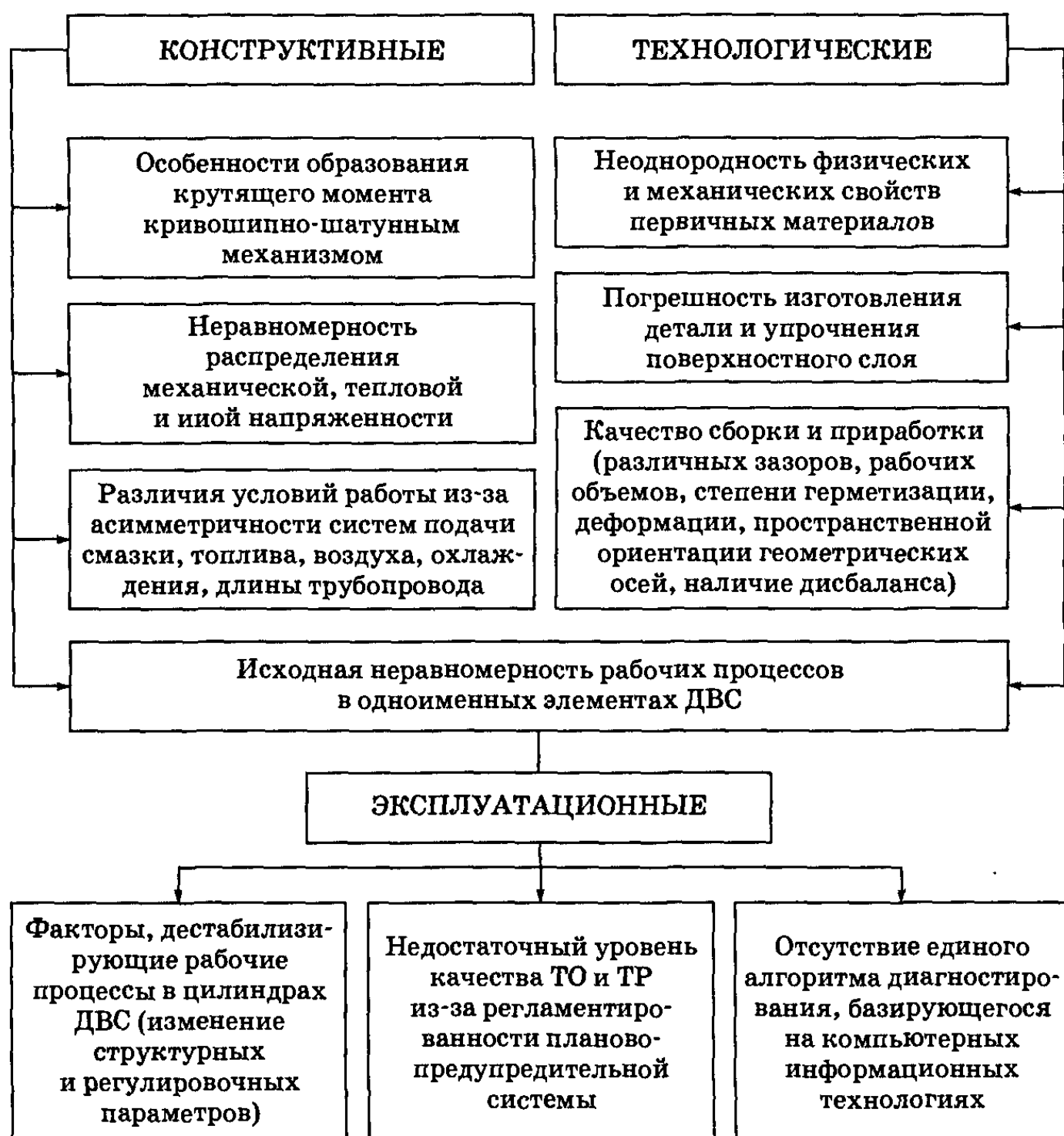
Рис. 1.1. Причины изменения технического состояния элементов
